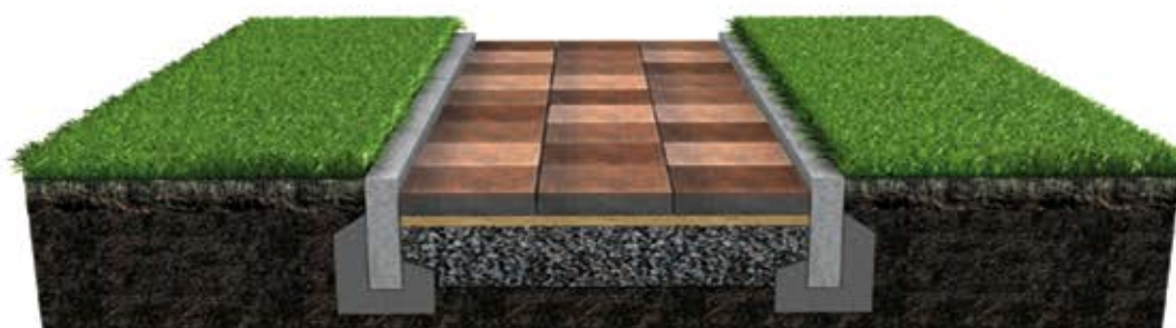
Właściwe ułożenie płyt lub kostek brukowych
